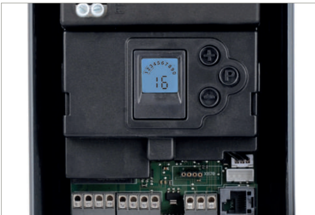
Un indicateur de défauts très explicite! Les 16 derniers affichages peuvent être rappelés à tout instant sur l'écran LCD afin de contrôler l'état du système.
