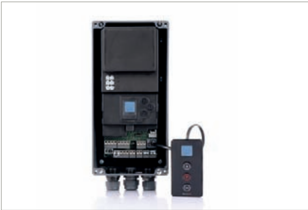
Système de programmation EOS: le protocole de programmation unique à afficheur LCD pour tous les opérateurs Marantec. Il peut être programmé à hauteur d'homme grâce au boîtier externe Command 108.
