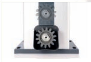
Le pignon d'entraînement est ajustable en hauteur jusqu'à 160 mm maximum. L'opérateur s'adapte à toutes les typologies d'installations concernant la hauteur de la crémaillère.
